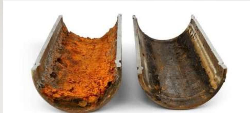
Corte transversal de uma tubulação de uma rede hidráulica de combate a incêndio mostrando corrosão por MIC.
